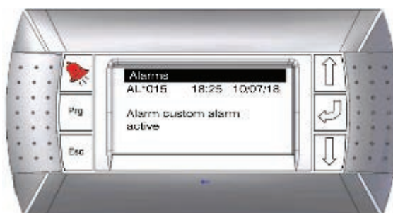
Beispiel für Textbearbeitungsmenü bei anwenderspezifischem Alarm (links) und Alarmausgang (rechts)
