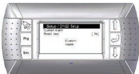
Beispiel für Textbearbeitungsmenü bei anwenderspezifischem Alarm (links) und Alarmausgang (rechts)
